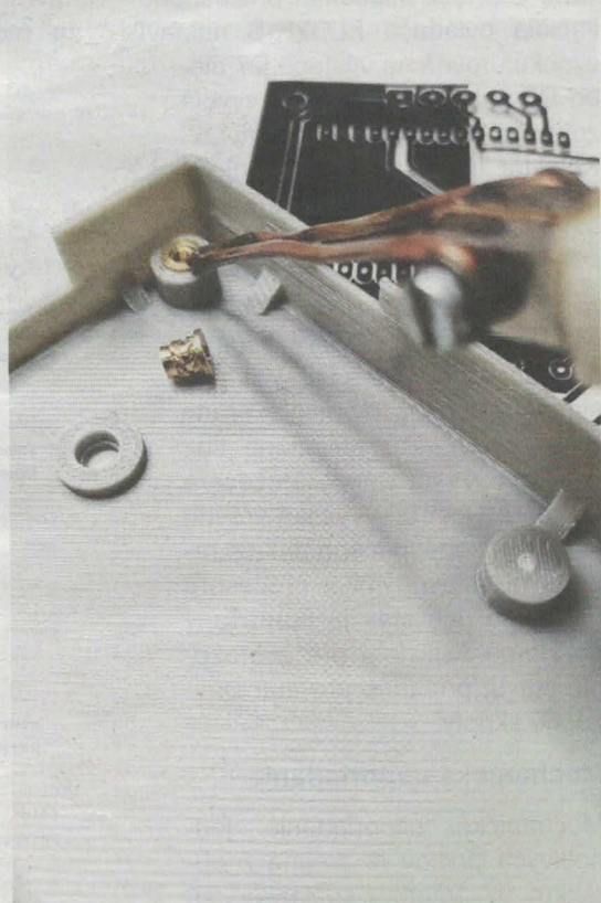
→ Obr. 8. Závitové vložky M3 upevníme zahriatím spájkovačkou
