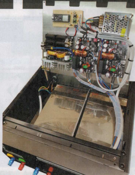
→ Obr. 18. Horný hliníkový plech pre uchytenie DC/DC meničov a kabeláže
